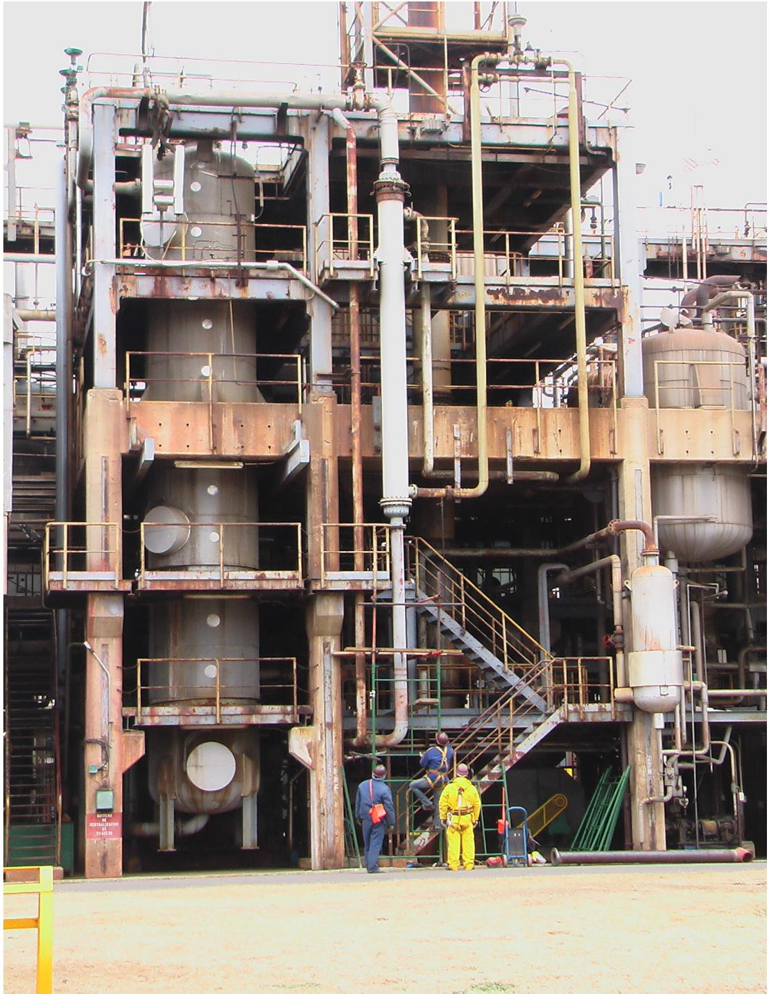
Foto 7: Detalle del scrubber de abatimiento de gases ácidos.
